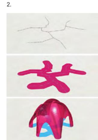
Figura 2. Exploración formal del pabellón funicular, subdivisión de la malla en secciones cuadrilaterales. / Fotografía: Díaz, I. y Díaz, C. (2016). Pabellón Funicular, Universidad Piloto de Colombia, Semillero de Tecnología Expresiva.
